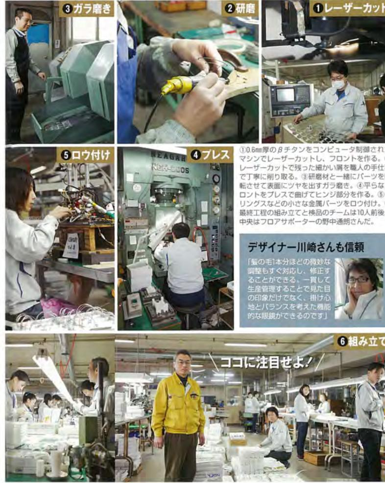
①0.6mm厚のβチタンをコンピュータ制御されたマシンでレーザーカットし、フロントを作る。②レーザーカットで残った細かい屑を職人の手仕事で丁寧に削り取る。③研磨材と一緒にパーツを回転させて表面にツヤを出すガラ磨き。④平らなフロントをプレスで曲げてヒンジ部分を作る。⑤クリングスなどの小さな金属パーツをロウ付け。⑥最終工程の組み立てと検品のチームは10人前後。中央はフロアサポーターの野中道明さんだ。
