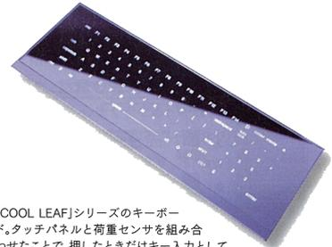
「COOL LEAF」シリーズのキーボード。タッチパネルと荷重センサーを組み合わせることで、押しただけでキー入力として認識し、軽く触れた場合はマウスパッドとして機能できるようになっている。
