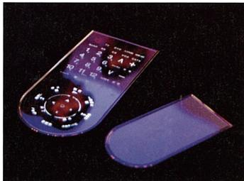
文字が点灯したリモコン。点灯していないときは下部に円形のサインの光が回ようになっていて、暗い場所でもどこにリモコンがあるかがすぐわかるようになっている。
