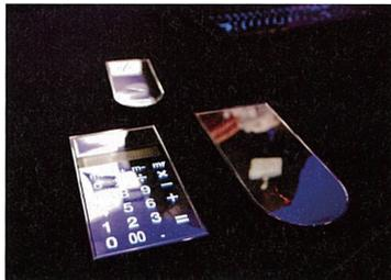
キーボードと同じく鏡面に仕上げられた電卓とリモコン。表面に触れると電源が入ってバックライトが点灯し、文字が浮かび上がる仕組みを持つ。
