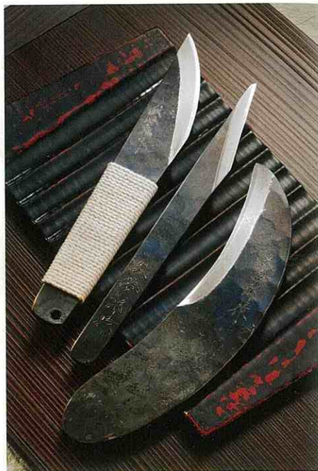
(上から) 「ナマソリ」:全長202mm。 「切り出し」:全長202mm。 「竹ひご割り」:全長190mm。
